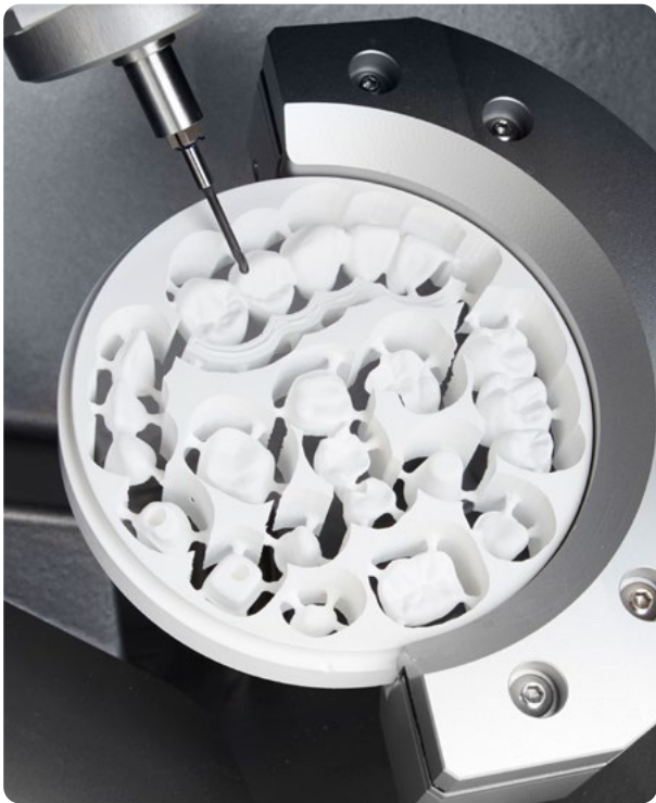
Die R5 schwenkt die Spindel (B-Achse) um bis zu ±35°. Dadurch kommt der Werkstückhalter mit nur einer beweglichen Achse (A-Achse) aus und das gesamte System gewinnt an Stabilität.
